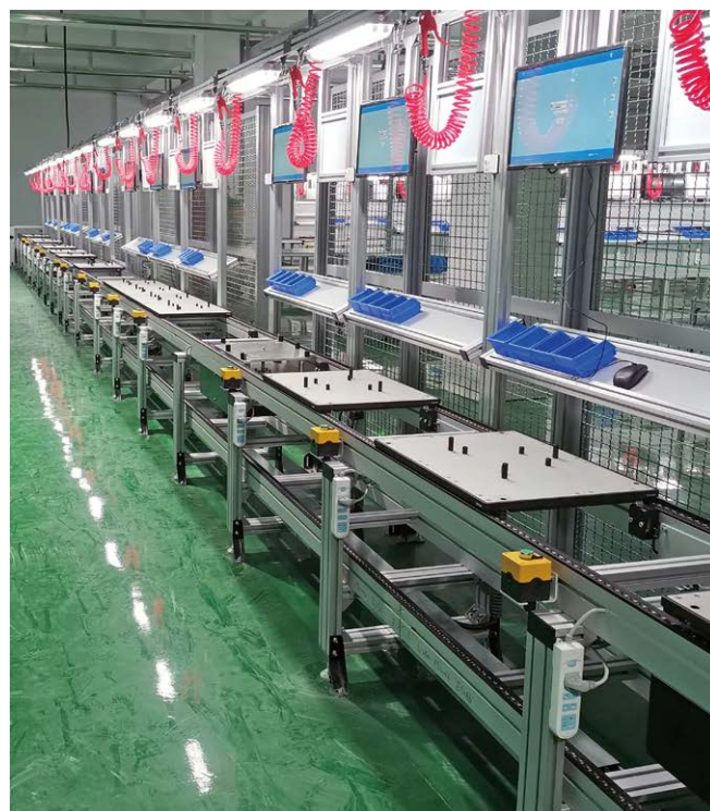
Sistema de control del transportador de pallets
