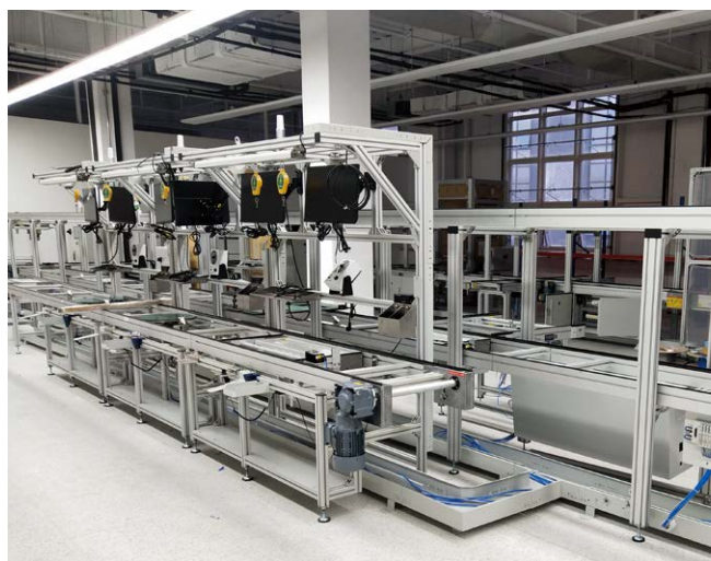
Sistema de control del transportador de pallets
