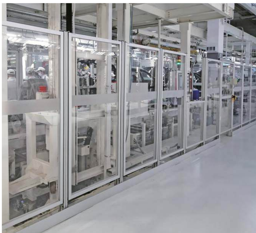
Guarda de Protección para Maquinaria
