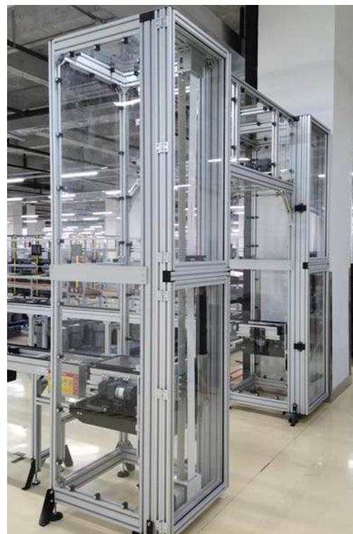
Estructura para Elevador
