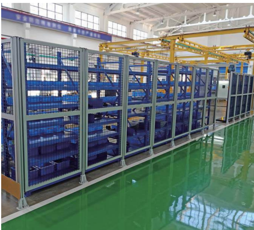
Cerco de Protección para Almacén
