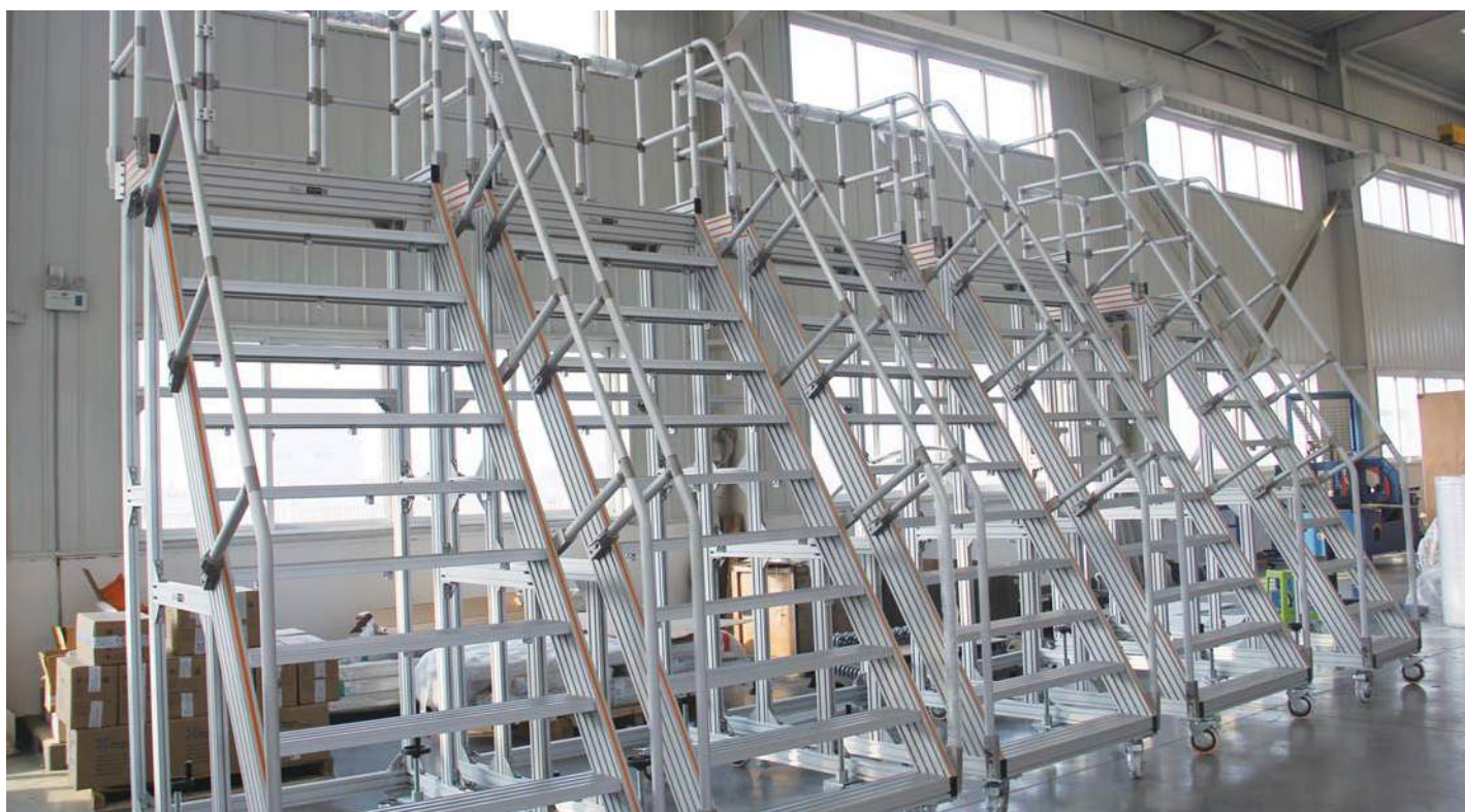
Plataforma para Mantenimiento
