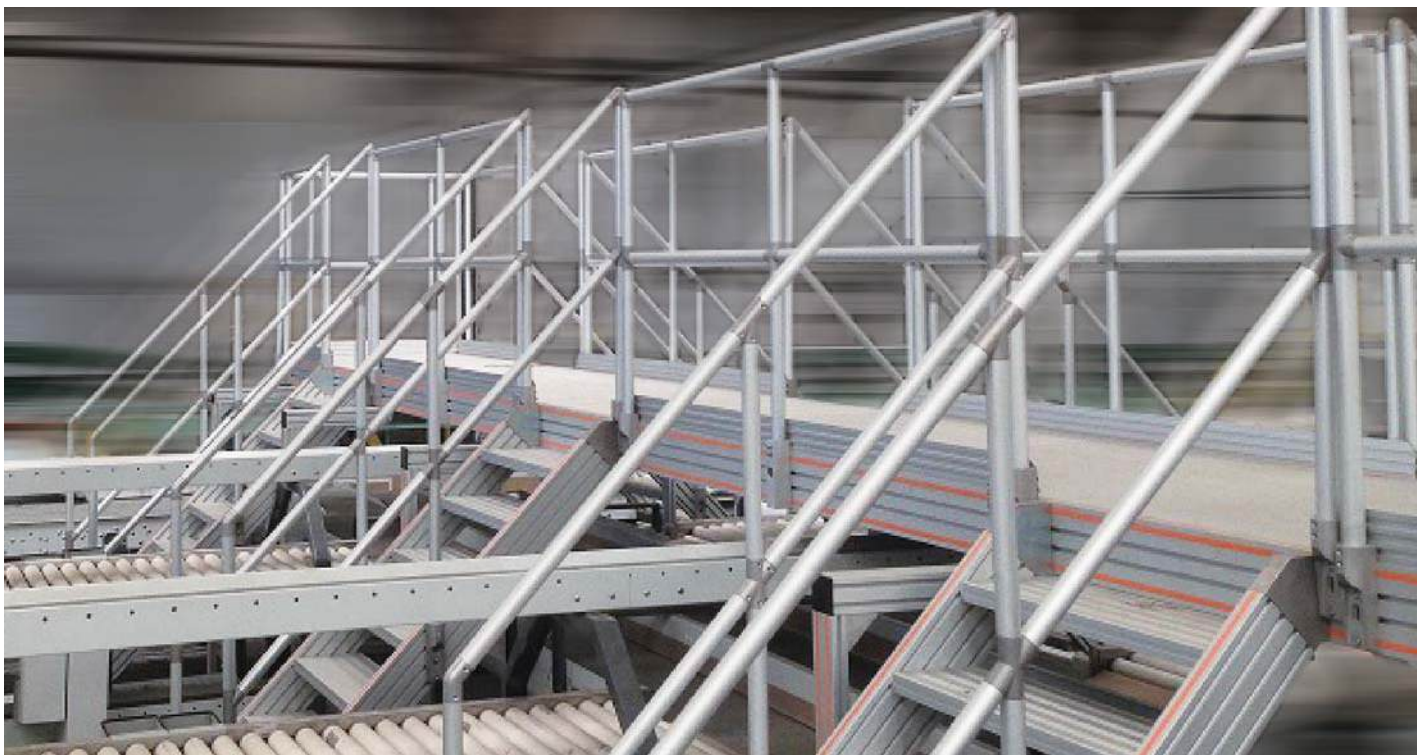
Puente (paso de gato) para Transportador
