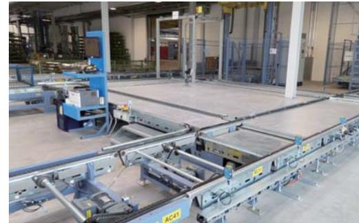
El sistema de transportador de pallets incluye Transportadores de rodillos robustos con transmisión por cadena, Transportadores de cadena y el rodillo de la Unidad de Elevación y Transferencia transversal. Tiene las características de una estructura simple, ensamblaje y mantenimiento conveniente.
