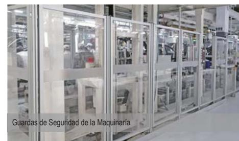
Guardas de Seguridad de la Maquinaria
