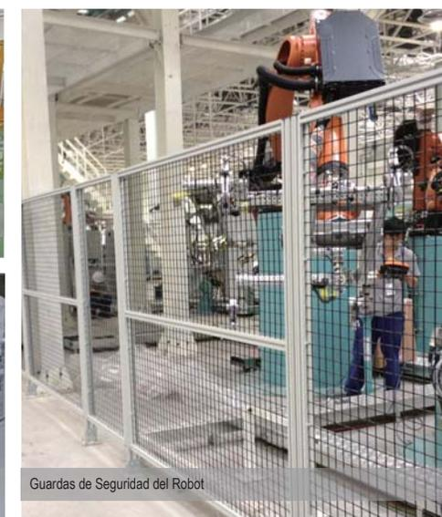
Guardas de Seguridad del Robot
