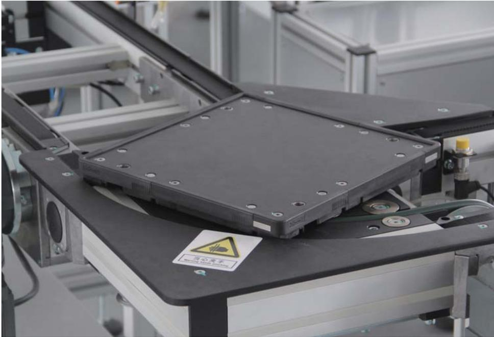
El pallet es la herramienta de transferencia para transportar la pieza de trabajo a cada estación. El tope detendrá el pallet una vez que llegue a la estación de trabajo. El medio de transporte operará continuamente.
