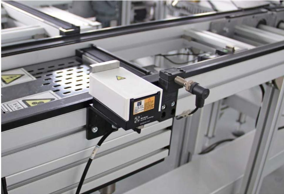
El dispositivo de control del transportador es una parte esencial del sistema de transferencia de pallets. Se utiliza para detener, transferir y distribuir los pallets para llevar a cabo un control automático y flexible del sistema de transferencia de pallets.
